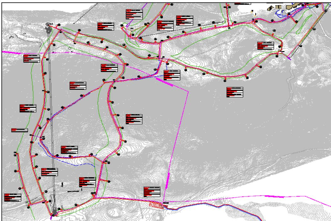
Immagine della skiarea Malcesine- Monte Baldo (c.a 35ha, con indicazione dei pozzetti, tubi in ghisa sferoidale, linee Mt/Bt, fibre ottiche, cavi dati per l'innevamento programmato artificiale)
