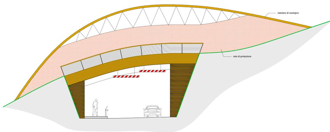
PROSPETTO SOTTOPASSO - ALLESTIMENTO RETE DI PROTEZIONE STAGIONE INVERNALE
