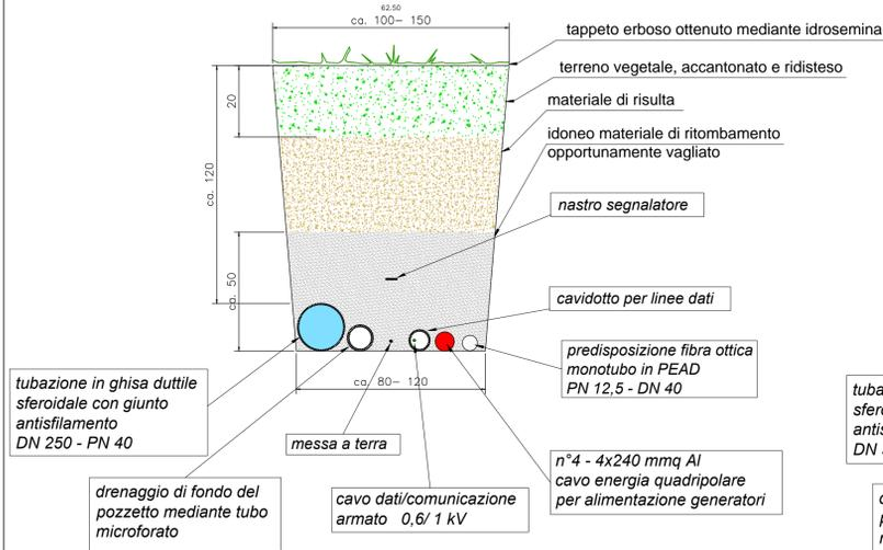
SEZIONE TIPO SCAVO SETTORE "MALGA LAGHETTO" (TRATTO A-B) - SCALA 1:10
